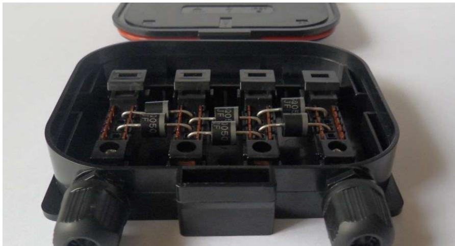
By-pass diodes in de aansluitdoos aan achterzijde van een PV paneel.
