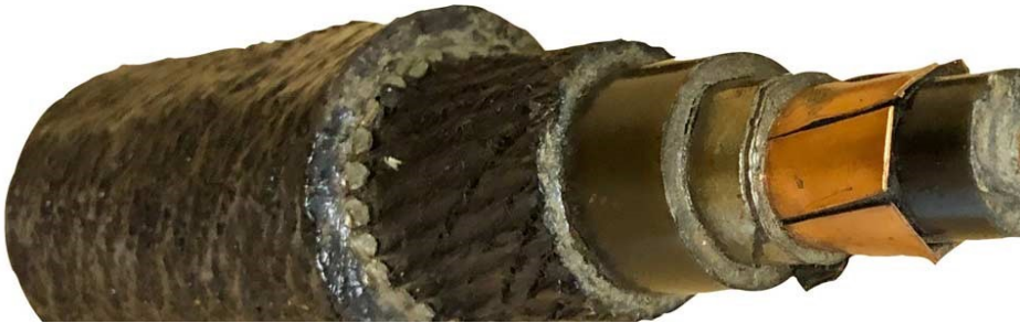
De coaxkabel die in de zeebodem werd gelegd tussen Schotland en Newfoundland
